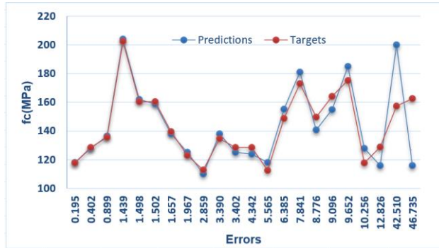
Hình 4.4 Biểu đồ biểu thị mối quan hệ giữa sai số với kết quả thực tế và dự đoán của GA
